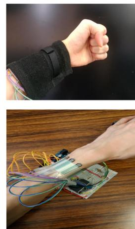
FMG計測による指先動作の解析
