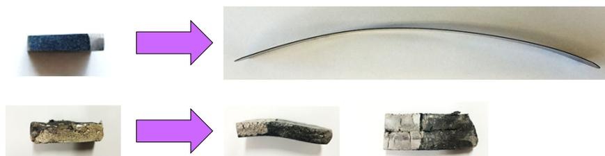
下: AZ31 汎用合金 (10% 程度の圧延で破壊)
