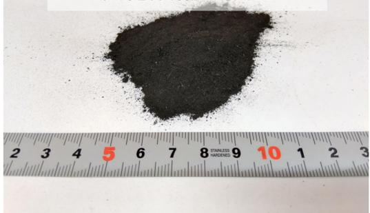
電炉での棒鋼生産に使用(コークス代替)
